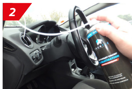
Introduire le tuyau d'1 mètre dans chaque aération et pulvériser
